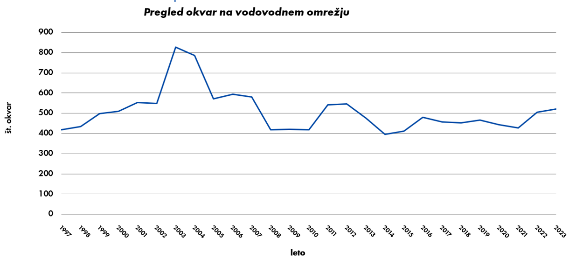
Graf 3: Pregled okvar na vodovodnem omrežju od 1997 do 2023
